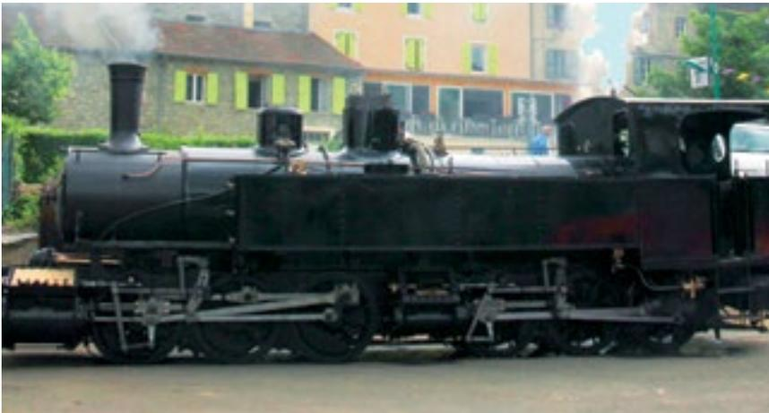
La locomotive Mallet 403 a été complètement démontée. Résultat : plus de 5000 pièces détachées ont été restaurées et réassemblées. Une nouvelle chaudière a même été construite.
